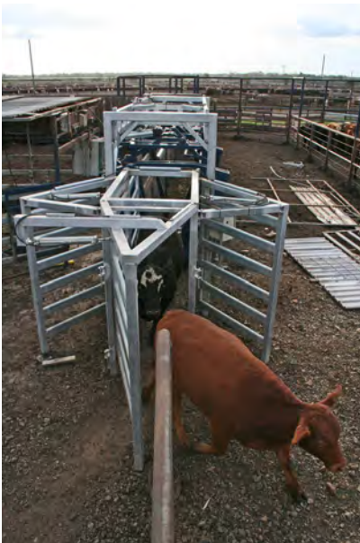
Pneumatic 3-way fan draft
